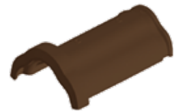
Brown Bretagna 2 Ridge 36,2 x 25,1 x 12,5 / 3 Units/m / 3,15 Kg. Max. Slope 87%-40.5°
