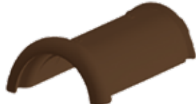
Brown Bretagna 1 Ridge 44,5 x 27 x 12,5 / 2,3 Units/m / 3,50 Kg. Max. Slope 87%-40.5°
