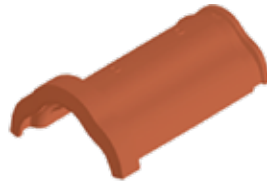
Red Bretagna 2 Ridge 36,2 x 25,1 x 12,5 / 3 Units/m / 3,15 Kg. Max. Slope 87%-40.5°
